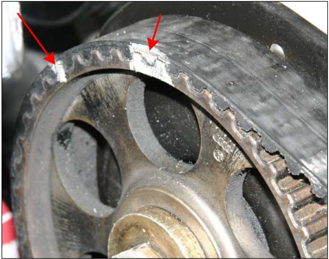
Bild 10: Nockenwellenrad und Markierung des Zahnriemens
