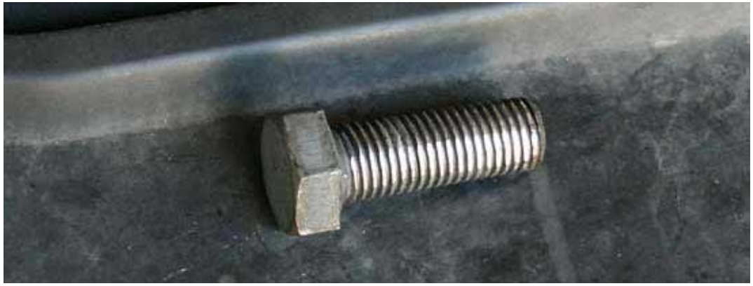
Bild 8: Absteckdorn für die ESP: Eine M16 Schraube zurecht feilen
