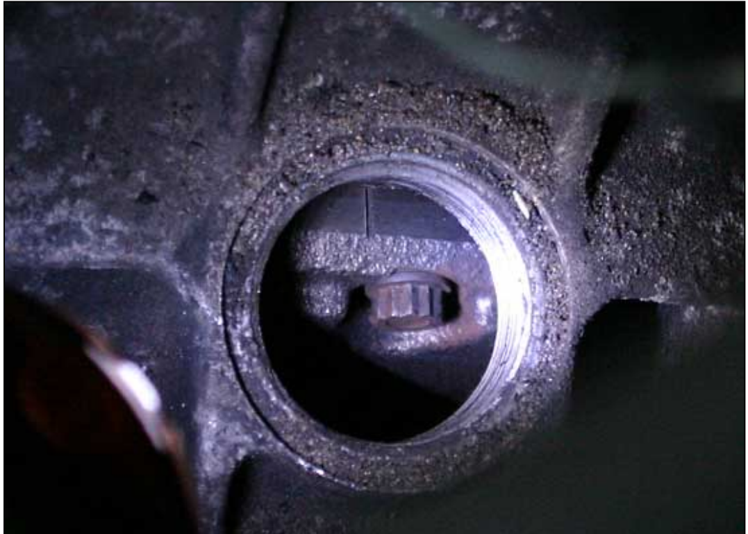
Bild 3: Die OT-Markierung auf dem Schwungrad. Zu finden in einem Guckloch der Getriebeglocke.
